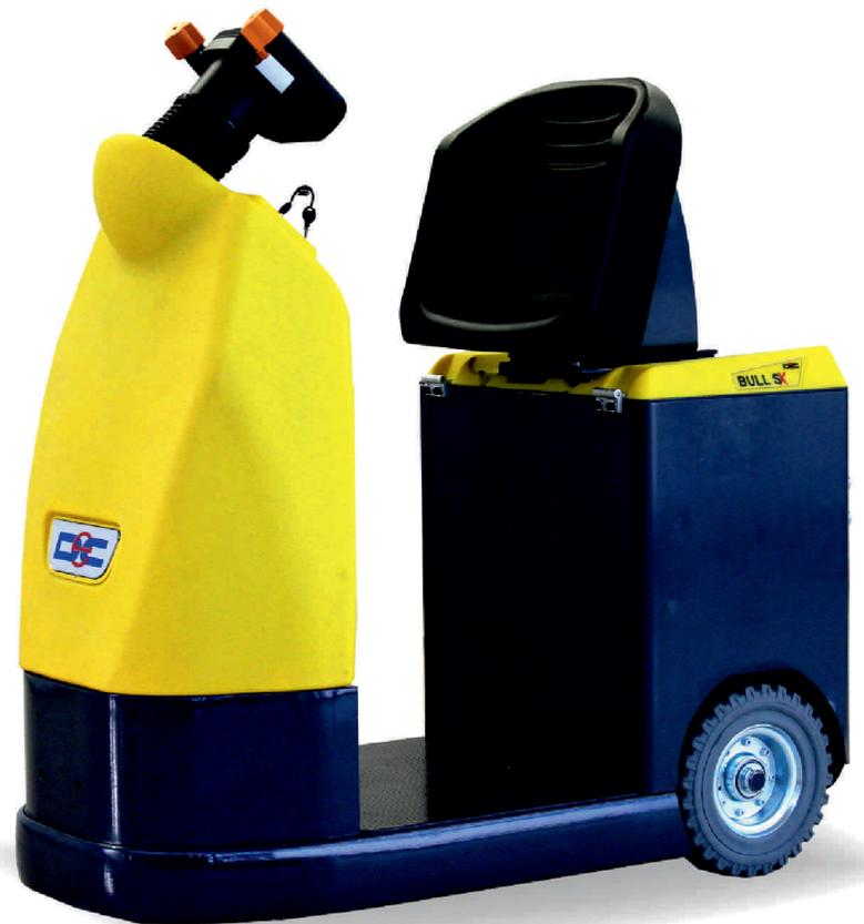
**RAHMEN:** Aus dickwandigem Blech, um eine selbsttragende Struktur zu erhalten.
