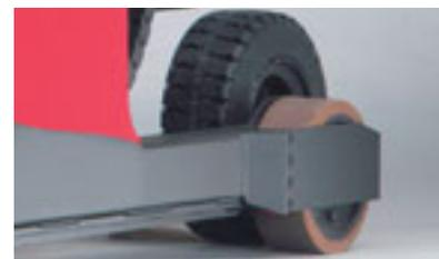
Für den kombinierten Innen-/Außen-Einsatz empfehlen sich Super-Elastic-Räder (M 1200 S). Oder eine Kombi-Bereifung, wenn der Stapler über unebene Böden rollen soll.
